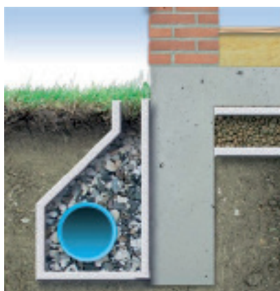
Grund- och källardränering till hus
