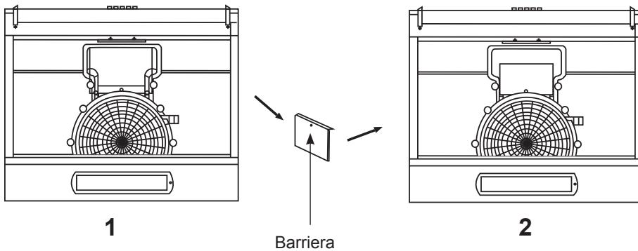
**Attenzione:** La presa d'aria (2) dovrebbe essere installata con l'adattatore per presa d'aria e collegata con il condotto della presa d'aria se il coperchio è rimosso. L'apertura della presa d'aria 2 non può essere lasciata aperta.
