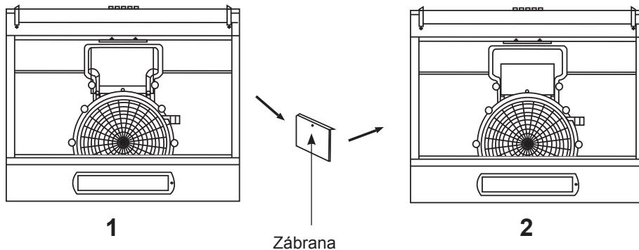
**Pozor:** Ak je odstránený kryt, výstup odvádzania vzduchu (2) by mal byť nainštalovalaný s adaptérom na odvádzanie vzduchu a pripojený ku kanálu na odvádzanie vzduchu. Otvor výstupu na odvádzanie vzduchu 2 nesmiete nechať otvorený.
