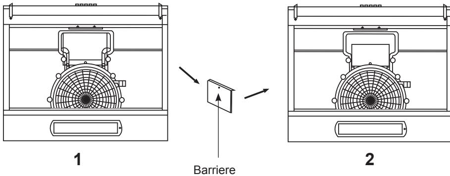
**Achtung:** Die Abluftöffnung (2) muss mit dem Abluftöffnungsadaptor angebracht und mit dem Luftabzugsrohr verbunden werden, sobald die Abdeckung der Abluftöffnung entfernt wurde. Die Öffnung der Abluftöffnung (2) darf nicht offen gelassen werden.
