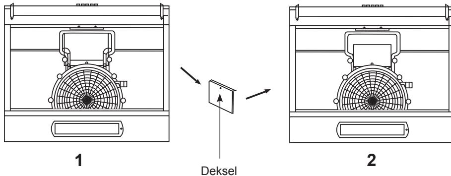
**Opgelet:** De luchtauitlaat (2) moet met de luchtafvoeradapter gemonteerd worden en op het luchtafvoerkanaal worden aangesloten als het deksel verwijderd is. De opening van de
