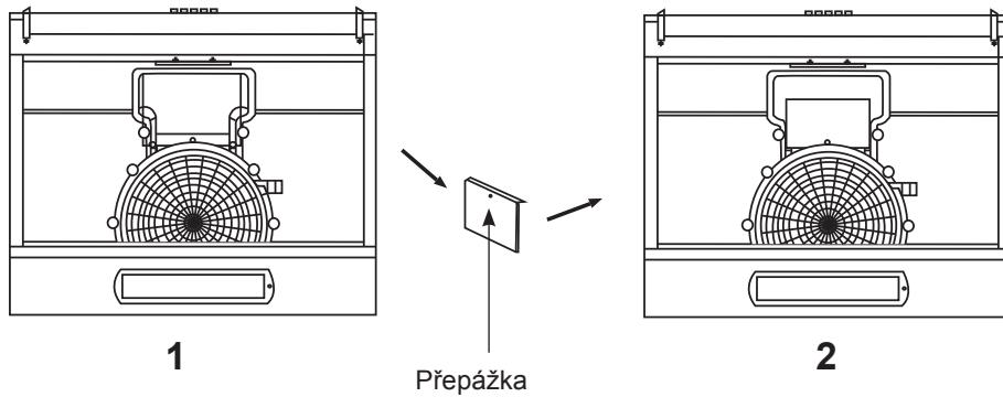
**Pozor:** Když jsou kryty odstraněny, musí být vývod vyfukovaného vzduchu (2) nainstalován s adaptérem pro výfuk vzduchu a připojen ke kanálu pro odtah vzduchu. Otvor výfuku vzduchu 2 nesmí být ponechán otevřený.
