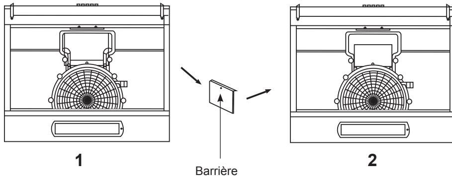
**Attention :** La sortie d'évacuation d'air (2) devra être installée avec l'adaptateur d'évacuation d'air et reliée à la conduite d'évacuation d'air si le couvercle est retiré. L'ouverture de la sortie d'évacuation d'air (2) ne doit pas rester ouverte.
