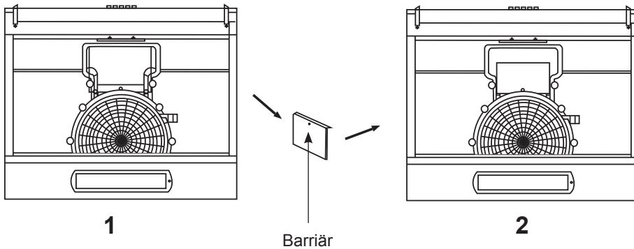
**Observera:** Det utströmmande luftutsläppet (2) skall monteras tillsammans med luftadapters utströmning och anslutas till luftkanalens utströmning om locket tas bort. Det utströmmande luftutsläppet 2 får inte lämnas öppet.
