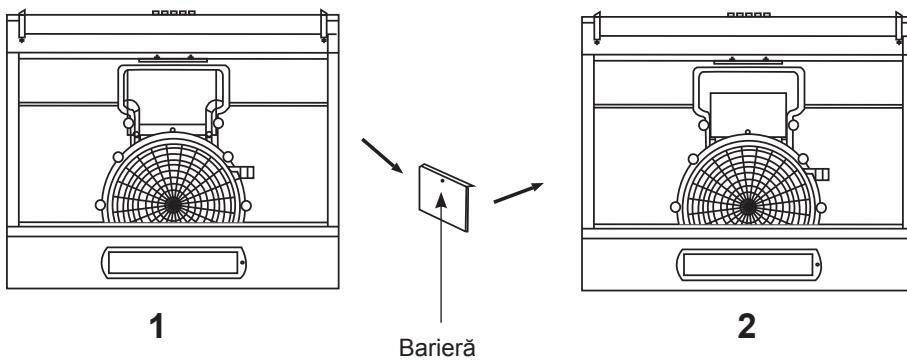
**Atenție:** ieșirea de aer uzat (2) trebuie instalată cu adaptorul de aer uzat și legată cu conducta de aer uzat dacă este scos capacul. Deschiderea de la ieșirea aerului uzat 2 nu trebuie lăsată deschisă.
